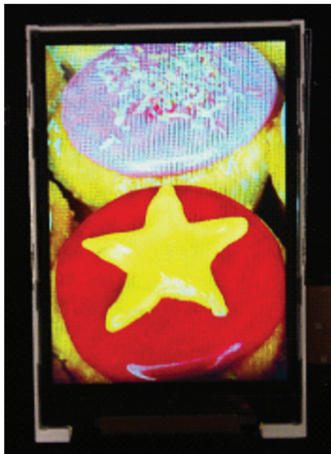
图 7 叠层隔垫物原型机显示画面 Fig.7 Display image of 2.4 in QVGA prototype
